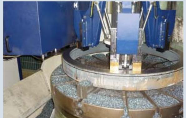
▲ Drei Klemmblocken halten den abzutrennenden Ring während der rotatorischen Bearbeitung in Position und sorgen für einen sauberen Schnitt.
