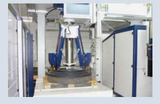
▲ Le dispositif de manutention dépose les anneaux coupés pour la prochaine opération d'usinage.
