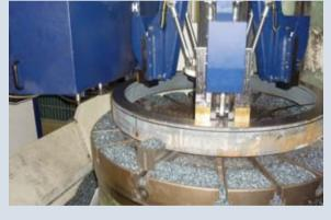
▲ Durant l'opération de coupe en rotation, trois mors de serrage maintiennent la pièce circulaire en position et garantissent un usinage parfait.
