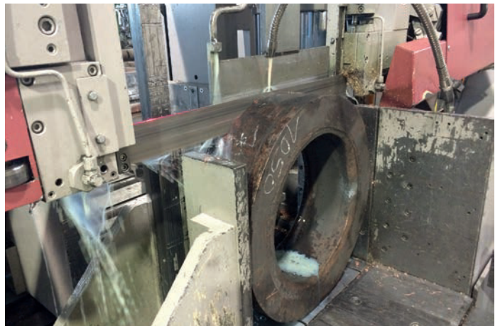
Bild 1: Konventionelle mechanische Bearbeitung von Ringen
