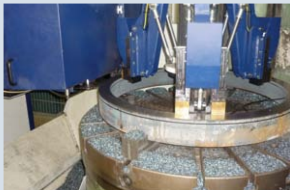
▲ Tre ganasce di serraggio trattengono in posizione l'anello da tagliare durante la lavorazione rotativa, assicurando al contempo un taglio preciso.
